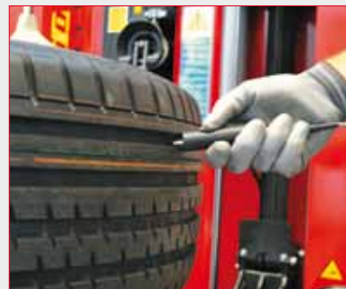
medição da profundidade da banda de rodagem
