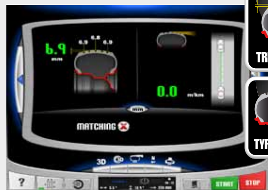
Profundidad de la banda de rodadura y deriva de la rueda Profundidade da banda de rodagem e derivação da roda
