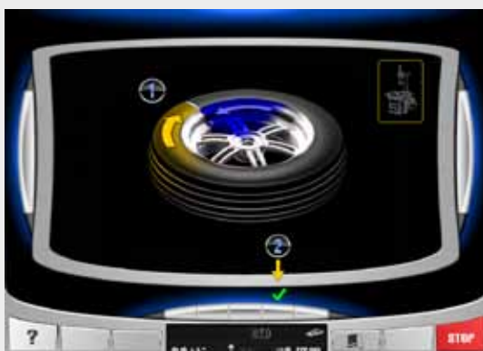
Excentricidad radial y lateral de la rueda Excentricidade radial e lateral da roda
